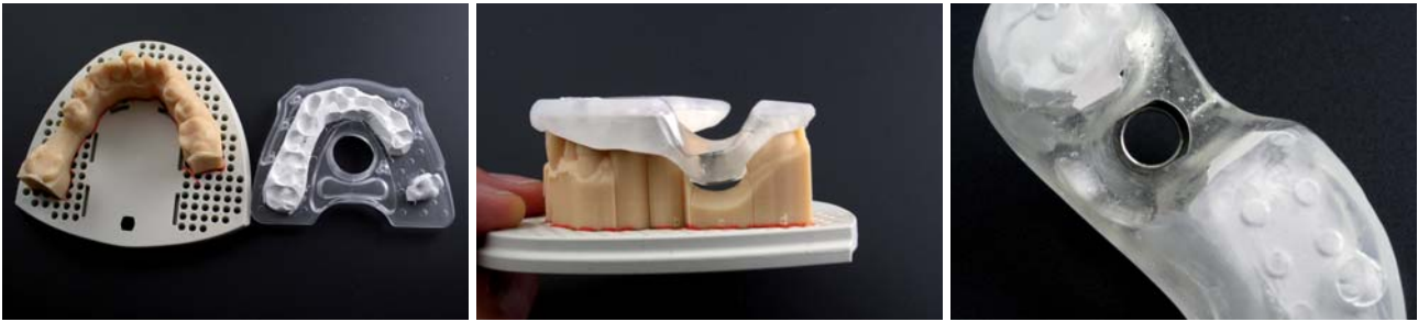
Abb. 9: Zentrale Fertigung der Bohrschablone durch Umarbeitung der Röntgenschablone (rechts) mittels CNC Technologie (SICAT, Bonn). – Abb. 10: Fertiggestellte Bohrschablone. – Abb. 11: Detailansicht Bohrschablone: Einpolymerisierte Hülse für die Implantation mittels Straumann Guided Surgery Kit (Straumann, Freiburg).
